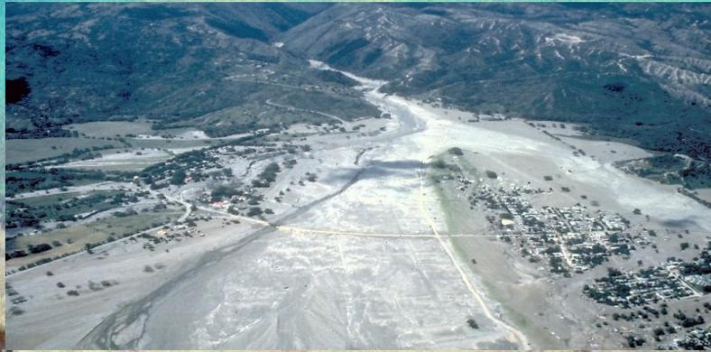
Rio Lagunilla y área afectada de 34 km<sup>2</sup> , descarga de 27100 m<sup>3</sup>/s, volumen de 39.8 millones de m<sup>3</sup> en el ápice del abanico, velocidad de la onda frontal menor a 12 m/s (Pierson *et al.*, 1990)
